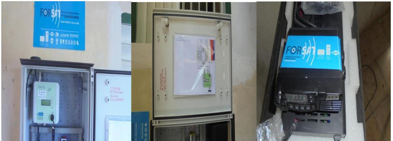
***Las EHA y las plantas de radio incorporadas en el sistema de vigilancia y alerta temprana para emitir información sobre las mediciones pluviométricas.***
